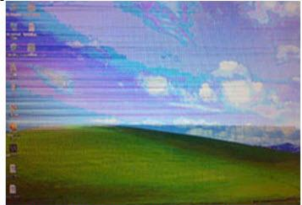
Hiện tượng của màn hình khi bị đứt các tín hiệu LVDS mang thông tin hình ảnh như TX0+, TX0-, TX1+, TX1-
