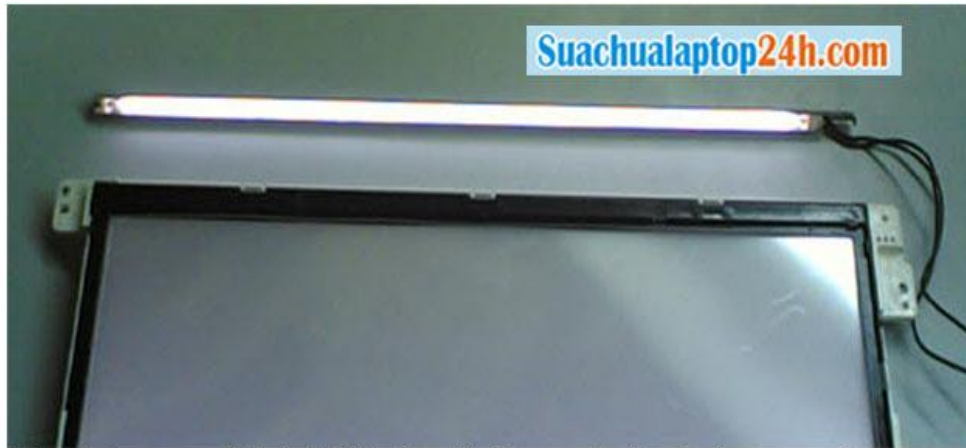
Đèn huỳnh quang ca tốt lạnh (CCFL) còn gọi là bóng cao áp, đèn này được cung cấp điện áp từ 600V đến 1000V khi phát sáng.
