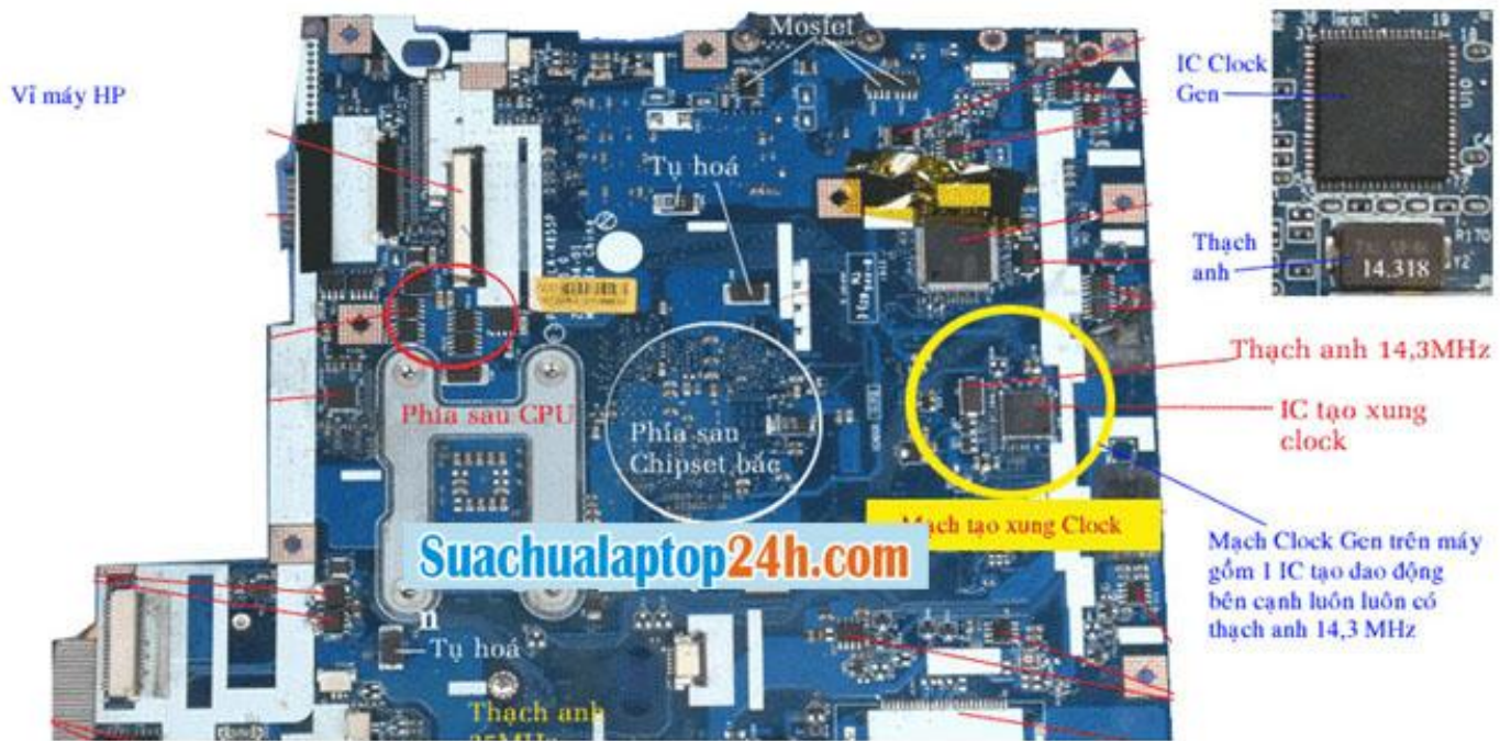
Mạch tạo xung Clock - Clock Gen trên máy Laptop HP mạch gồm một IC có thạch anh 14,3MHz đứng bên cạnh
